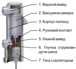
Мал. 2.1 Полюс з вакуумною камерою
