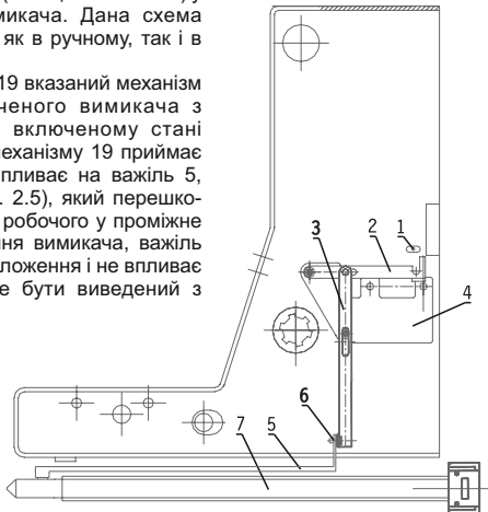
Мал. 2.6 Механізм блокування вимикача у проміжному положенні
